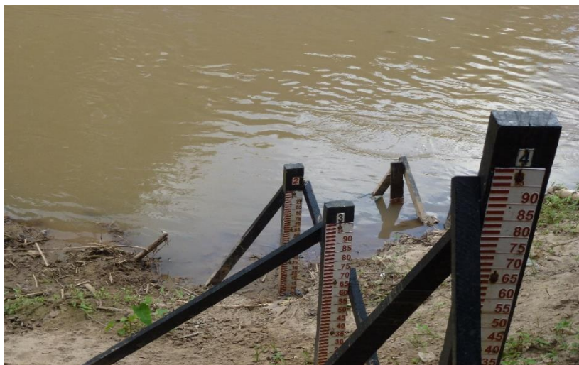
Figura 4.5 – Réguas instaladas para leitura de nível na estação Pedro do Rio
